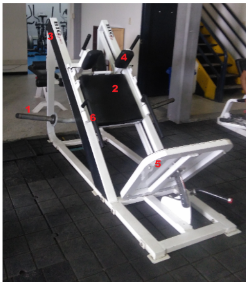
Figura 2. Material utilizado para la valoración de la 1 RM en Hack Squat: (1) soportes laterales donde se ubica el peso; (2) respaldo donde se apoya la espalda; (3) rieles por donde se moviliza la maquina (4) Soportes donde se apoyan los hombros
